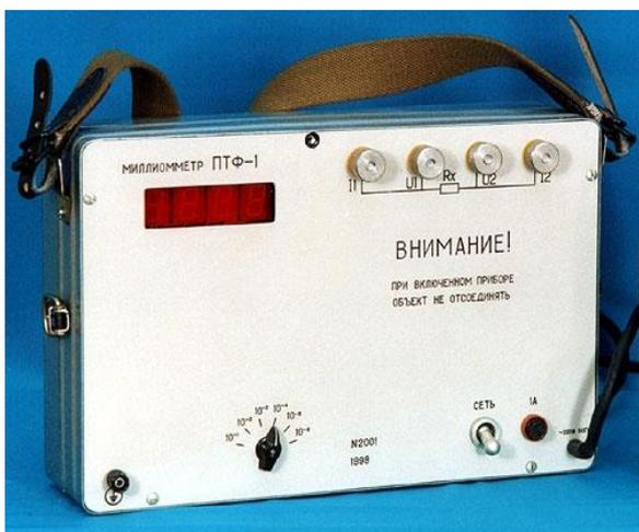
Цифровой миллиомметр ПТФ-1 по условиям эксплуатации относится к 4 группе и может использоваться как в закрытых помещениях, так и на открытых площадках в неагрессивной среде при температуре окружающего воздуха от -10 °С до + 40 °С и относительной влажности до 90 % при +20 °С.
