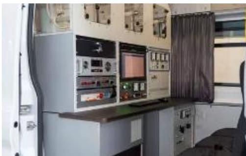
Передвижные электролаборатории ППУЗ предназначены для проведения испытаний подстанционного оборудования и распределительных устройств с рабочим напряжением до 35 кВ, а также диагностики силовых трансформаторов и высоковольтных вводов. Монтаж оборудования электролабораторий производится на шасси автомобилей, ГАЗ, “Газель”, ЗИЛ, КАМАЗ, ПАЗ, и др. по согласованию с Заказчиком.
